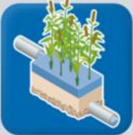
Nom Filtres plantés de roseaux à écoulement vertical (967 hab)
