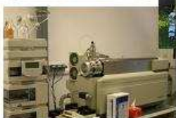
Appareil de chromatographie en phase liquide avec détection par spectrométrie de masse en tandem (LC-MSMS) pour l'analyse des médicaments et des pesticides
