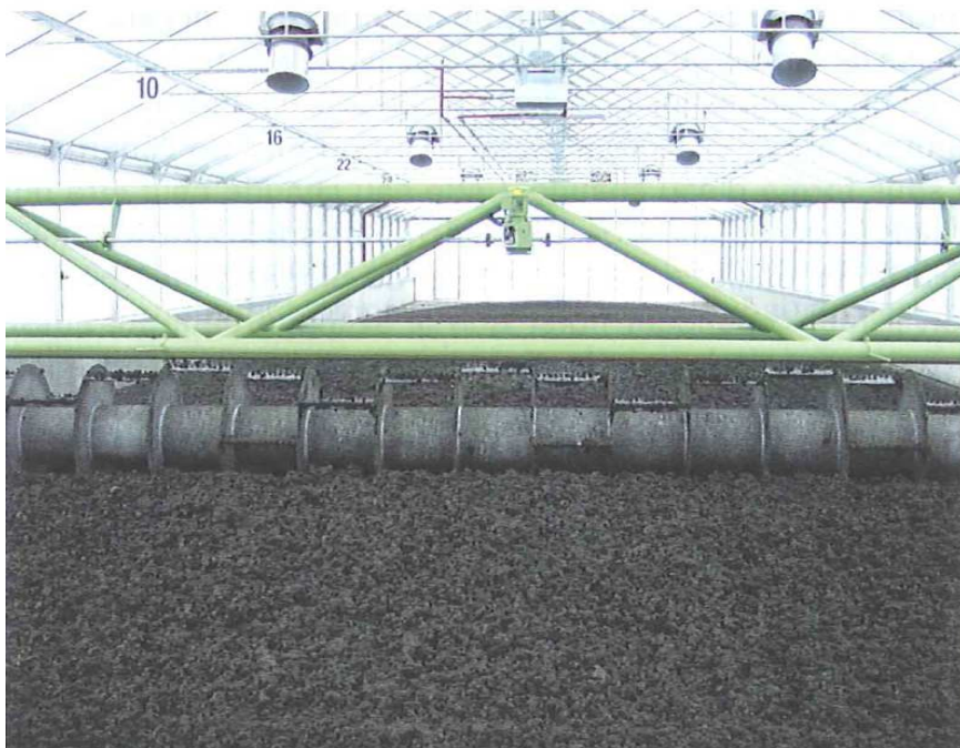
Figure 5 : Scarificateur en fonctionnement
