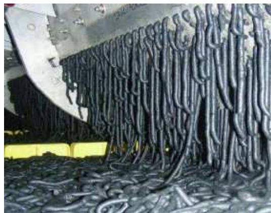
Figure 13 : Boue déshydratée extrudée entrant dans le sécheur
