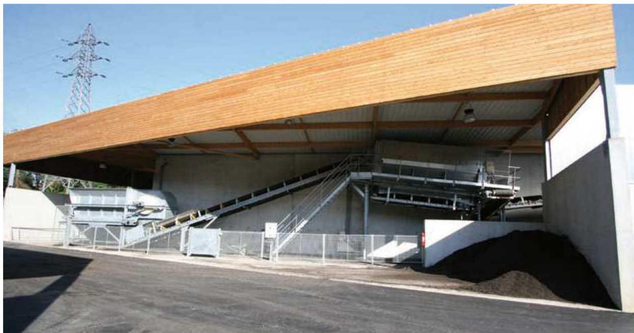
Figure 7 : Crible pour séparer le compost du support carboné
