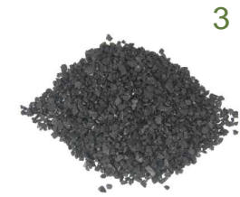
charbon actif (CA) S_{\text{spé}} \sim 1000 \text{ m}^2/\text{g}
