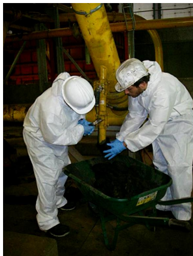
Prélèvement de boues séchées et de condensats de séchage.
