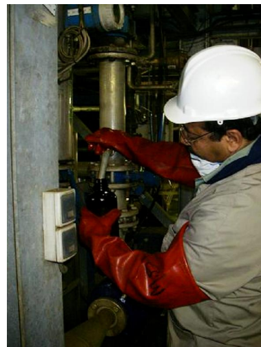
Prélèvement de boues séchées et de condensats de séchage.
