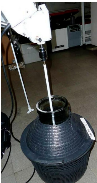
Réacteur verre mélangé par agitateur mécanique équipé d'une pale Téflon
