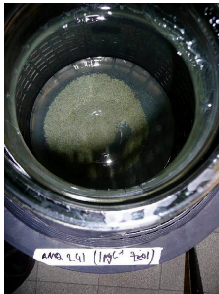
Mélange effluent Valfleury dopé en micropolluants + matériau adsorbant
