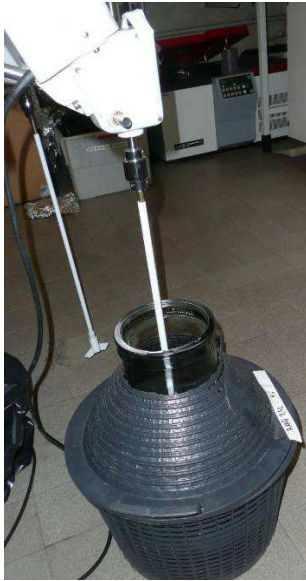
Récipient verre mélangé par agitateur mécanique équipé d'une pâte Téflon
