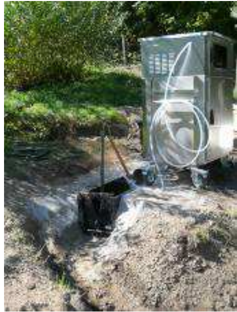
Figure 4 : Equipement utilisé pour la mesure de débit (canal venturi à gauche) et préleveur automatique réfrigéré (à droite)
