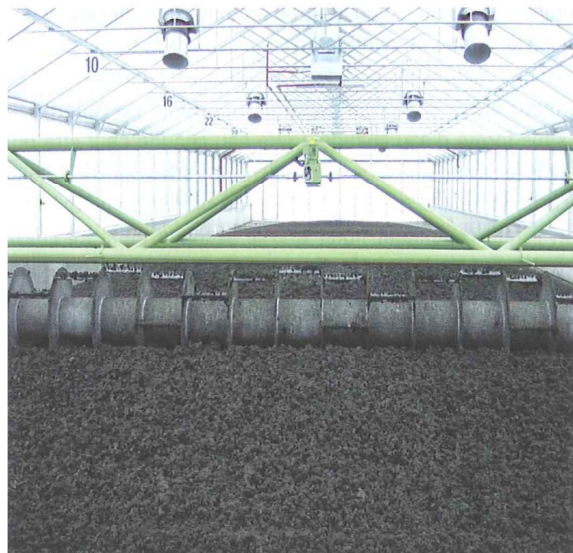
Figure 4 : Scarificateur en fonctionnement dans une serre
