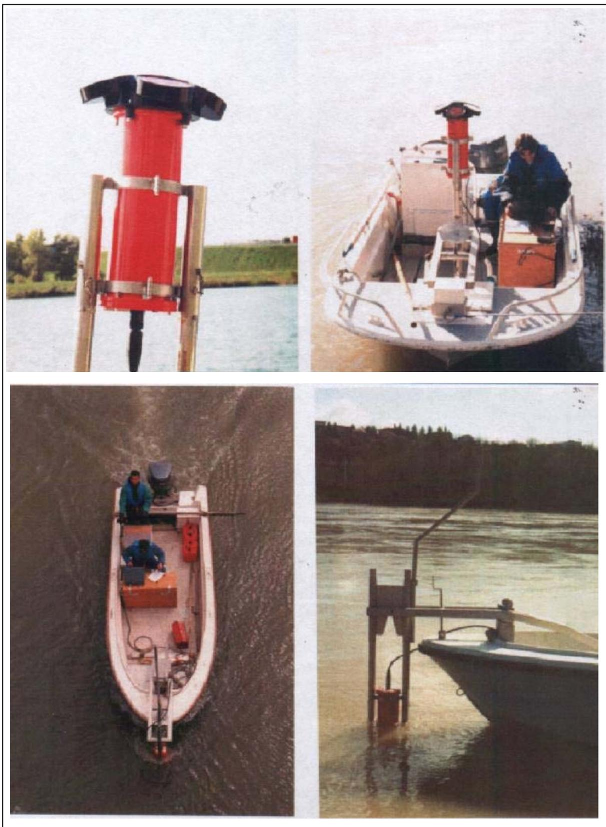
**Figure 6 : ADCP Broadband 600 kHz monté sur barque**
