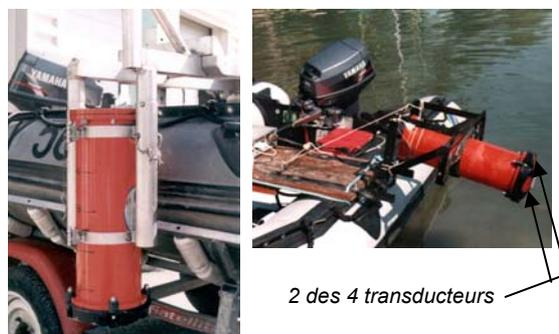
Figure 1 : L'ADCP Broadband 1200kHz de la CNR
