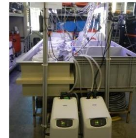
Système de régulation thermique
