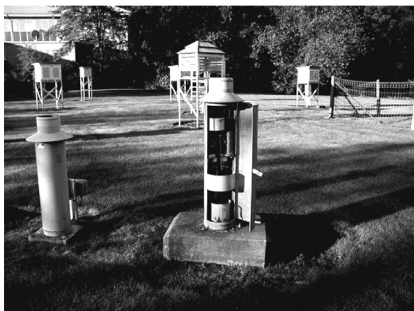
Figure 1 : Pluviographe à siphon de type Helmann-Fuess exploité à Uccle (Belgique) depuis 1898.
