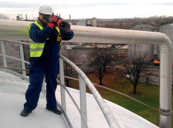
Détection d'émissions fugitives de biogaz par camera à détection de gaz (photos CH4Process et IRSTEA ).
