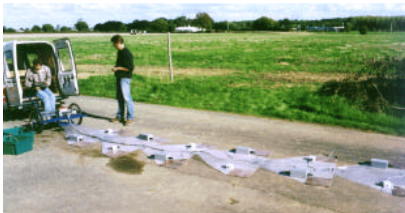
Figure 3 - L'équipement de mesures de résistivité en continu (CORIM d'Iris Instruments). On distingue les 6 tapis portant les électrodes capacitives
