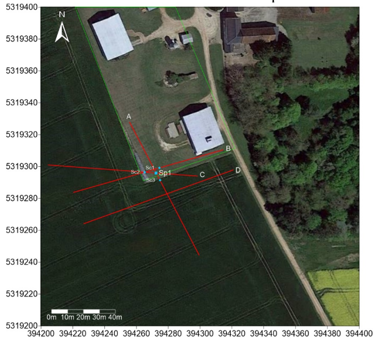
Fig. 1 – Situation géographique du site d'étude de Villamblain UTM 31N (© Google Earth). Les profils TRE sont tracés en rouge et les sondages géotechniques en bleu. La zone encadrée en vert délimite le terrain habité.
