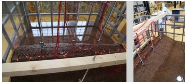
Fig. 1 - Modèle analogique et instrumentation mis en place au laboratoire. La longueur de la digue en argile est d'environ 1.5 m.
