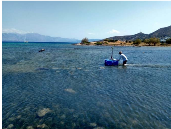
Fig. 1 –Acquisition des données EM multi-fréquentielle sur le site d'Elounda (Grèce)
