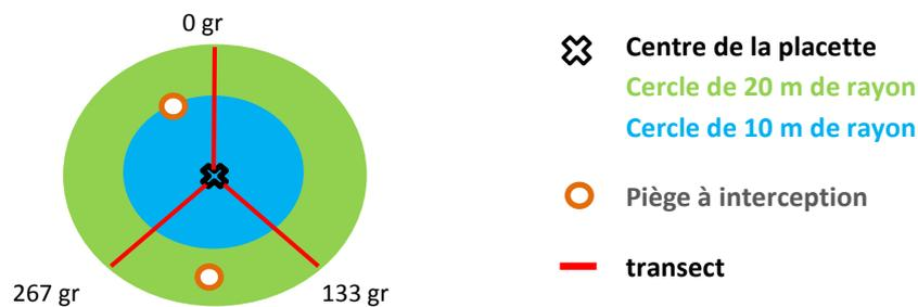
Figure n°5 : Positionnement des pièges à interception
