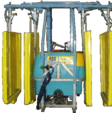
PULVERISATION S21 Panneaux récupérateurs
